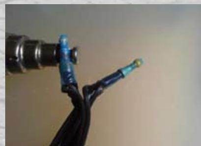
6.6. Проверьте, что термоусадочная часть конусной муфты правильно обжала провода. Нагрейте клейкую массу так, чтобы она начала плавиться и стекать сквозь провода.
