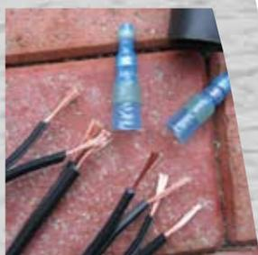
5.4. Распрямите равномерно жилы кабеля и выровняйте провода так, чтобы максимально приемлемое смещение на концах составляло не более 7 мм. Для удобства работы по сборке рекомендуем скрепить вместе концы с помощью хомутика.
